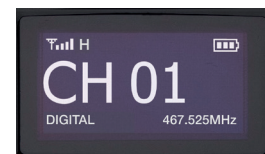
Affichage informatif qui indique à la fois le numéro de canal et la fréquence
